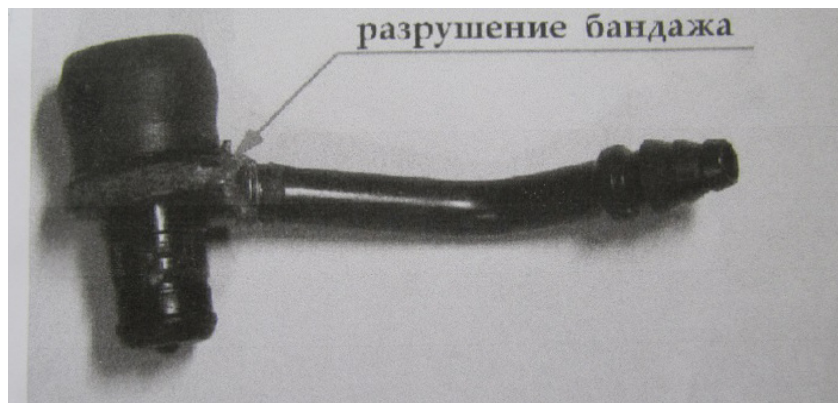
Рис. 4. Разрушение бандажа имеет четкие визуальные признаки и опережает по времени нарушение функционирования аспирационного клапана в целом. Это позволяет своевременно провести замену бандажа
